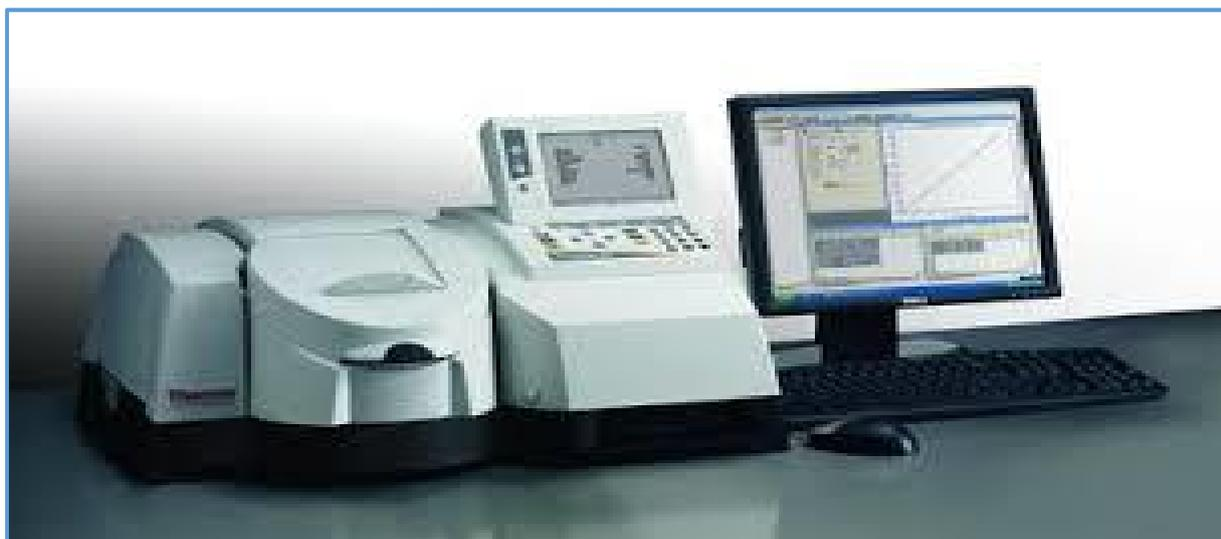
Figure 13: Spectrophotomètre UV pour la détermination de l'absorbance E270.
